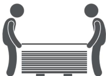
Coloque las láminas sobre los dos soportes de madera.
